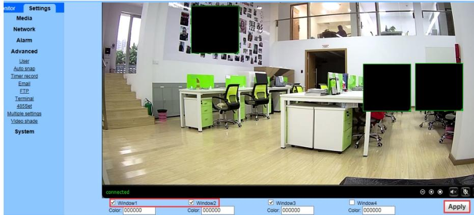
window にチェックを入れると、枠が表示されます。枠をドラッグしてビデオシェードの範囲は選定できます(「Apply」をクリックしてから枠が黒色になります)。
